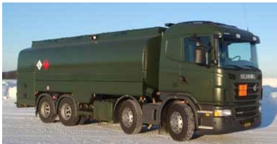
Tankbil 21, en trojänare som kan leverera både standard flygfotogen 75 och NATO-drivmedlet F34 som världsstöd när internationella partners landar i Sverige och till svenska luftfarkoster som nyttjar F34, till exempel Helikopter 16 (Black Hawk).
